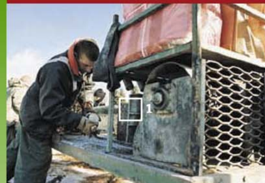
La barrière d'arrêt d'urgence (1) permet au travailleur de désactiver le mécanisme d'entraînement du treuil à l'ouverture de la porte. La barrière doit être fermée pour réactiver le mécanisme.
