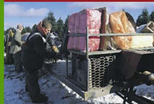
L'emballeuse vue de dos. On voit bien la prise de force et le grillage protégeant l'accès au treuil. Ce dernier est muni d'un dispositif sensible d'arrêt d'urgence.
